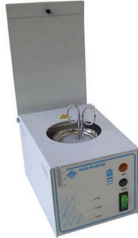
*Sterilizzazione delle sole estremità di lavoro a 235° c x tempi da 5 a 20 secondi richiedeva pre riscaldamento e sostituzione periodica delle microsfere. Vi si processava solo la parte lavorante dello strumento. Rovinava il «filo» delle lame.*
