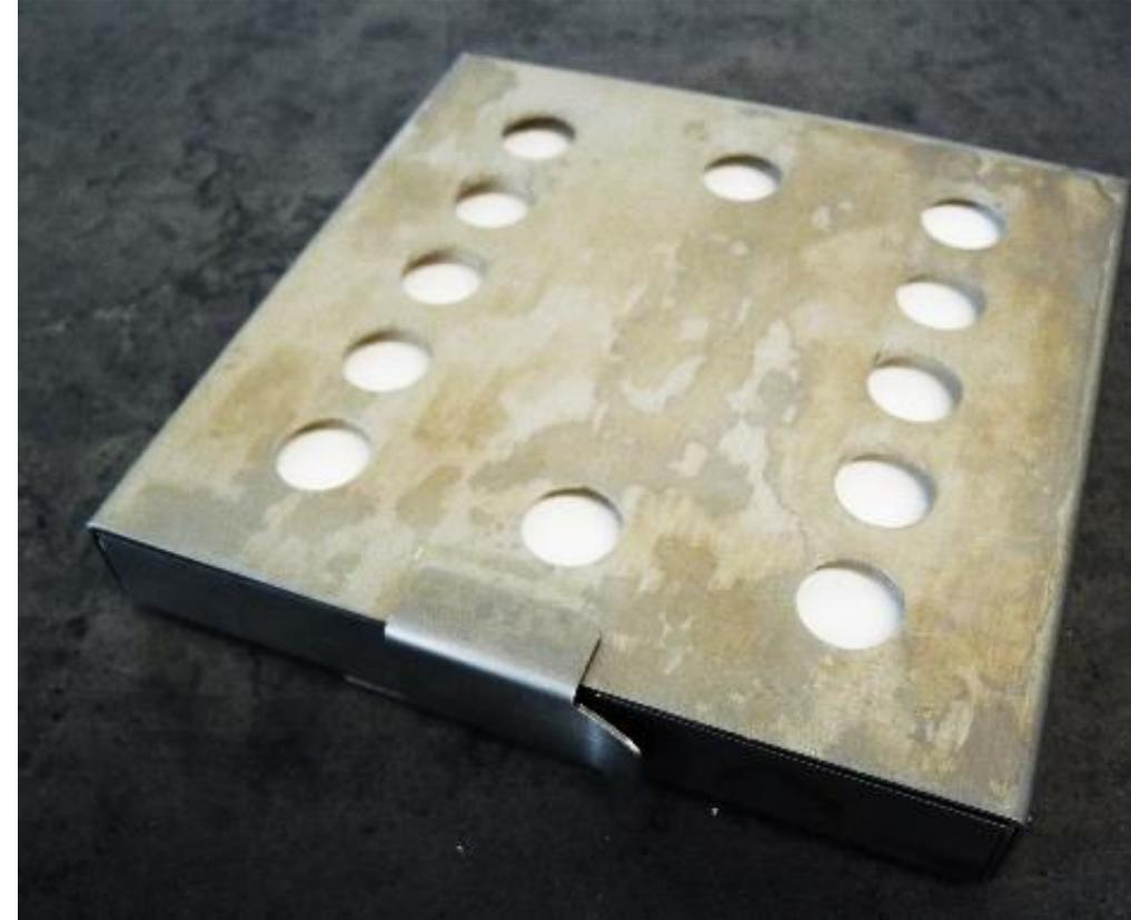
Pacco-test da assemblare, inserire nell'apposita teca forata e imbustare prima di utilizzare
