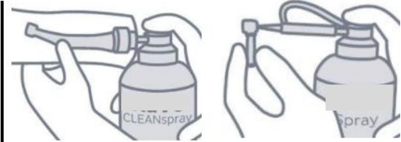
**4** Lubrificazione con olio compatibile in quantità mirate (2 secondi di erogazione)
