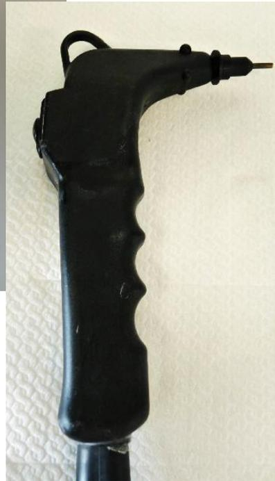
La vaporiera permette di ottenere *unicamente detersione meccanica* dello strumentario grazie a un getto di vapore sotto pressione. ***Non consigliata per studi odontoiatrici in quanto genera dispersione di materiale contaminato.***
