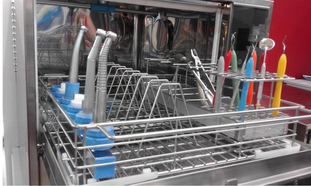
Permette deterzione e decontaminazione dell'esterno e dei condotti interni dei rotanti.
