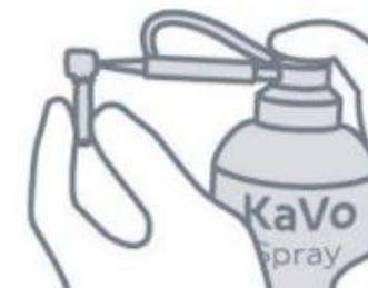
**4** Lubrificazione pinza di serraggio 1 volta alla settimana
