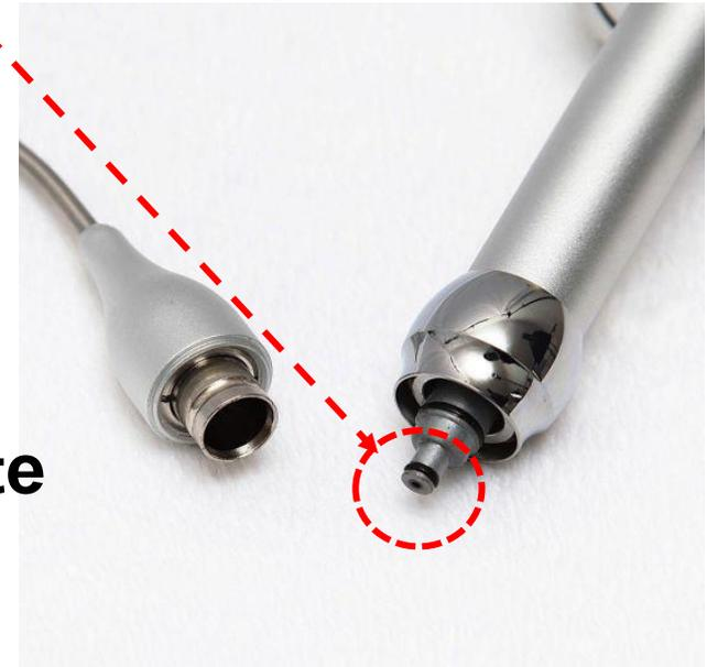
Manipoli di strumenti non rotanti richiedono **unicamente** **lubrificazione esterna delle guarnizioni** (O-ring) con vaselina in pasta
