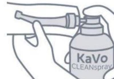
**4** Lubrificazione con olio compatibile in quantità mirate (1 secondo di erogazione)
