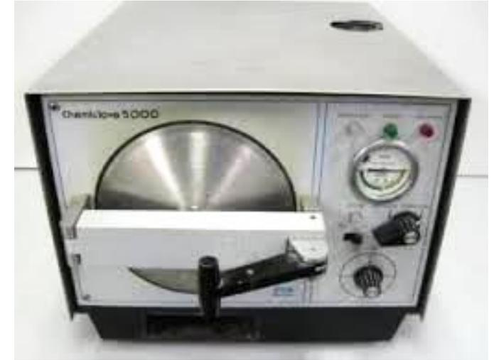
Autoclave a vapore chimico o **chemiclave**: utilizzava miscela di alcoli, chetoni, formaldeide, acetone. (a 130° C per 20 min) poi sostituita da **acqua distillata**
